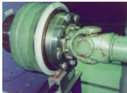
1: Drehmomentmessflansch des Typs T10F mit direkt angeflanschter Gelenkwelle
